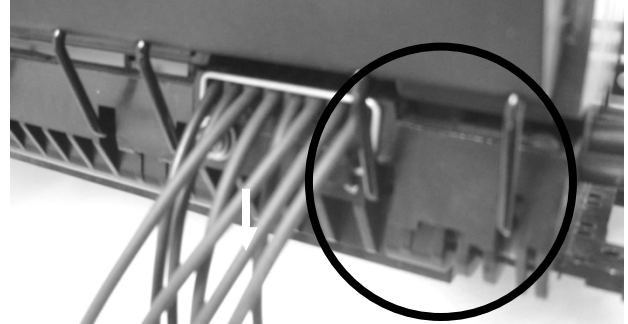
7.8 Coloque nuevamente este candado para cerrar apropiadamente la tapa de la terminal.
