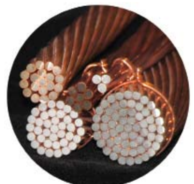
CCA utilisé pour câbles d'alimentation
