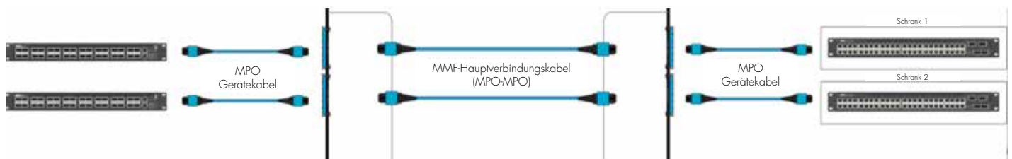
Abbildung 3. 40G-Switch-Konnektivität mit 40GBASE-SR4 (Anmerkung: zur Vereinfachung ohne Abbildung der Pins)
