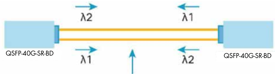
Duplex-Multimode-Glasfaser mit LC-Steckern an beiden Enden
