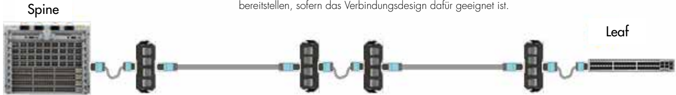
Abbildung 7: Leaf-Spine mit paralleler Glasfaser-Hauptleitung und Zwischen-DA
