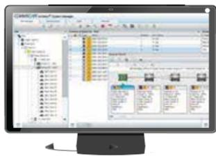
O software imVision System Manager combina dados sobre conexão com informações provenientes dos equipamentos de rede, terminais IP e outros sistemas, proporcionando assim um panorama completo de como está vinculada a camada de dispositivos conectados à rede com a camada física da rede.
