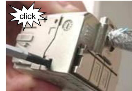
If necessary for re-termination, use a flat-blade screwdriver on the rear housing slots to gently open SEC. *Der Randsteckverbinder kann zur Wiederverwendung mit einem kleinen Schraubendreher durch die seitlichen Schlitz des Rückteils geöffnet werden.*
