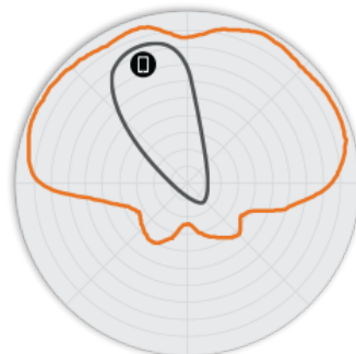
Figure 4. Diagrammes d'antennes Élévation R750 2,4 GHz
