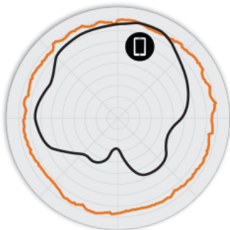
Figure 2. Diagrammes d'antennes Azimut R750 2,4 GHz
