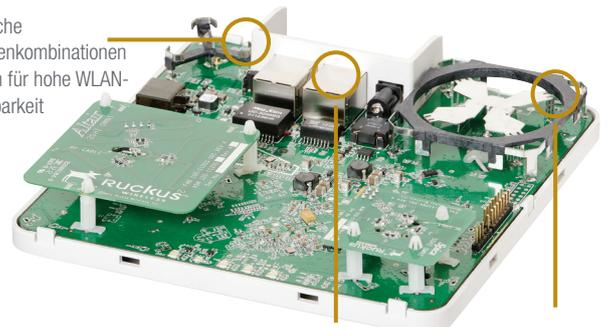
Unterstützung für einen Ethernet-Anschluss mit 10/100 MBit/s und einen 802.3af-PoE-Ethernet-Anschluss mit 10/100/1000 MBit/s
