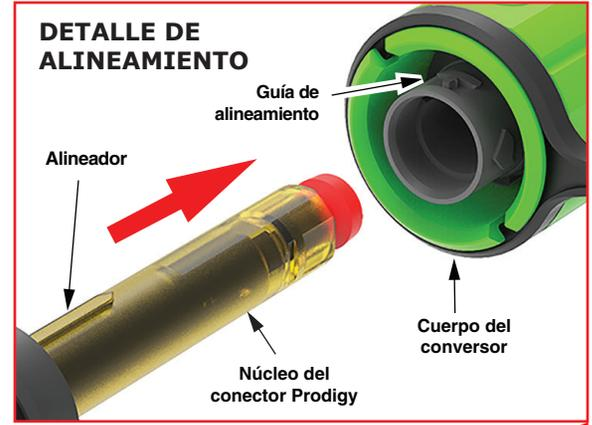
**NOTA:** Mantenga el cuerpo del conversor fijo mientras inserta el núcleo del conector en la apertura trasera del conversor, como se indica en el punto (c). Alinee el conector Prodigy usando el alineador y la guía de alineamiento como se muestra en el detalle superior.
