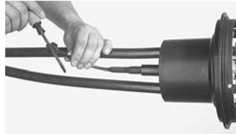
Si va a haber un aumento de cables en el cierre, libere el sello de GEL, girando en sentido contrario de las manecillas del reloj el activador, hasta que el sistema de la base pueda ser removido de la base del cierre.
