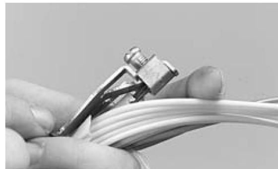
Coloque el sistema de relevación de esfuerzo del cable, sujetado el elemento central de tracción.
