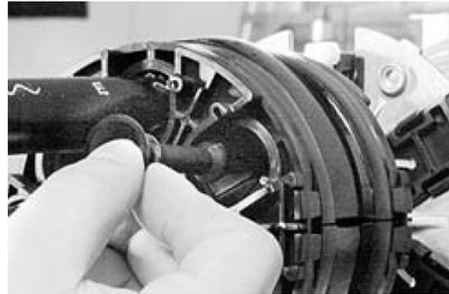
Antes de colocar ambos componentes en la base del cierre, cerciore de que los puertos no utilizados del cierre tengan un obturador para asegurar el sello del sistema.
