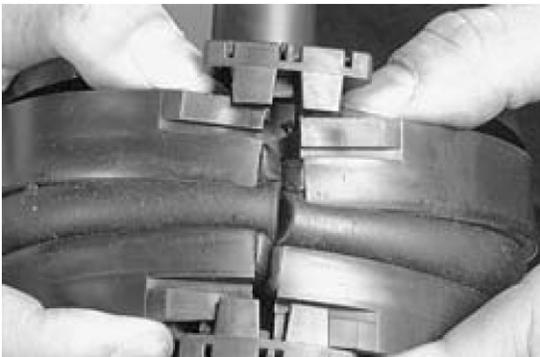
Con una ligera presión. Libere ambos lados del sello de gel de la base y abra el conjunto para insertar los cables
