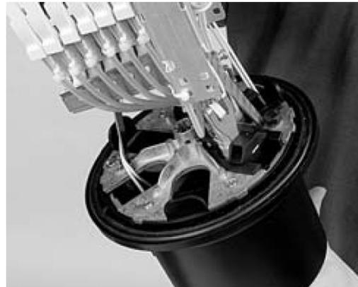
Deslice el sistema en la base del cierre, asegúrese de hacer coincidir todas las ranuras de la base metálica en la base del cierre.
