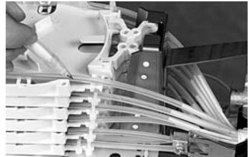
Inserte un tubo de transporte hasta la base del cable y marque el punto de corte en la charola.
