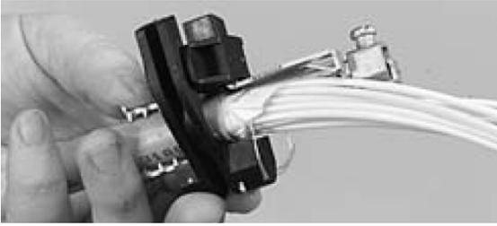
Coloque ambas mordazas en posición y sujételas con la brida sin fin, procure dejar el tronillo de la brida hacia la parte más ancha del sujetador del cable.
