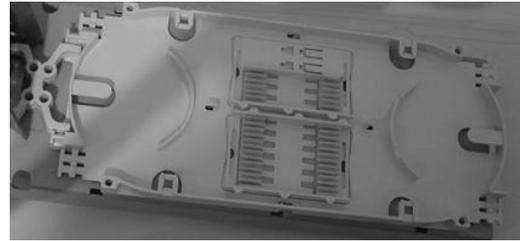
Elimine uno de los módulos de empalme preinstalados en la charola y sustitúyala por la que viene en el empaque del divisor.
