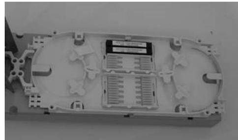
Instale el segundo divisor si así lo determina la ingeniería del proyecto y almacene las fibra de entrada y salida hasta que esté listo para el empalme correspondiente
