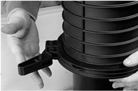
Asegúrese de que la junta tórica este en su lugar en la base del cierre y coloque el domo en su posición siguiendo las guías de ambas partes, es decir de la base y el domo accione el seguro de doble acción y con esto quedará completamente sellado el cierre.
