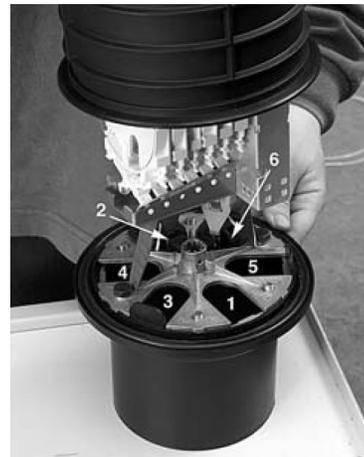
Remueva el domo del sistema y separe la base metálica de la base del cierre
