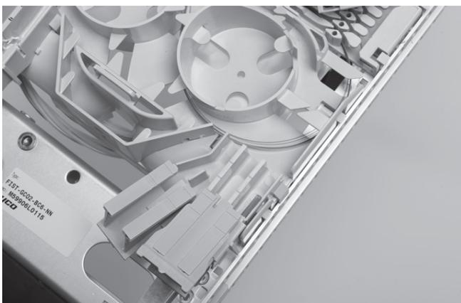
4.1.20 Dans le cas que la capacité dans la même cavité est trop petite, on peut insérer un set de cavité additive.
