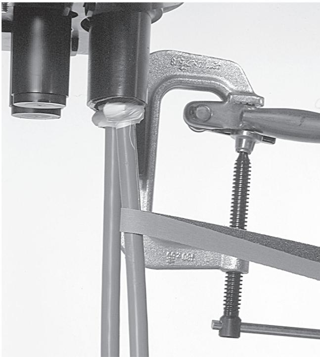
5.1.2 A l'aide du papier imprégné d'alcool isopropylique, nettoyer la gaine des câbles. A l'aide de la bande abrasive, abraser perpendiculairement à leurs axes la gaine des câbles sur la zone nettoyée. Enlever les résidus de l'abrasion avec un chiffon propre et sec.
