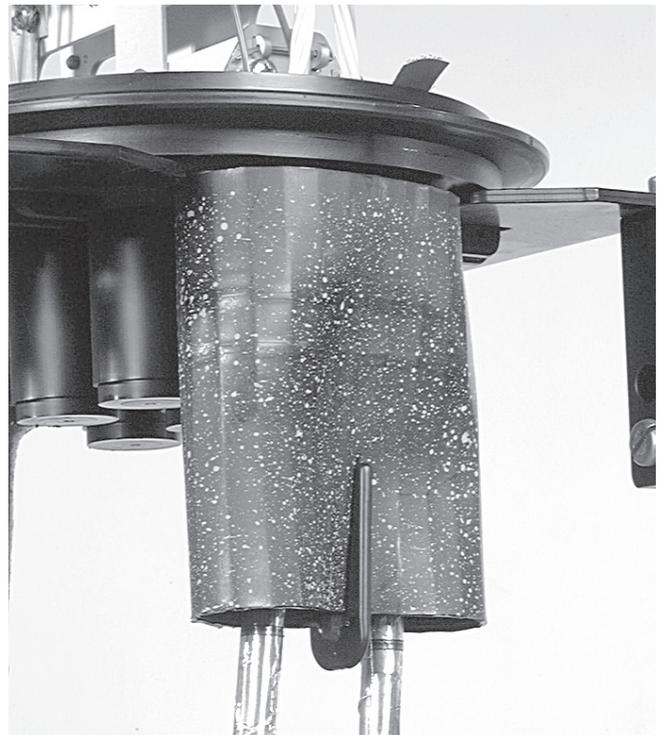
5.1.5 Ramener le manchon thermorétractable sur la tubulure ovale en butée sur l'embase. Insérer le clip de division. Vérifier que le manchon soit en butée sur l'embase et que le clip soit correctement positionné. A l'aide du ruban adhésif, relier ensuite les câbles entre eux à l'extrémité de la bande aluminium adhésive, pour les maintenir ensemble pendant la chauffe.
