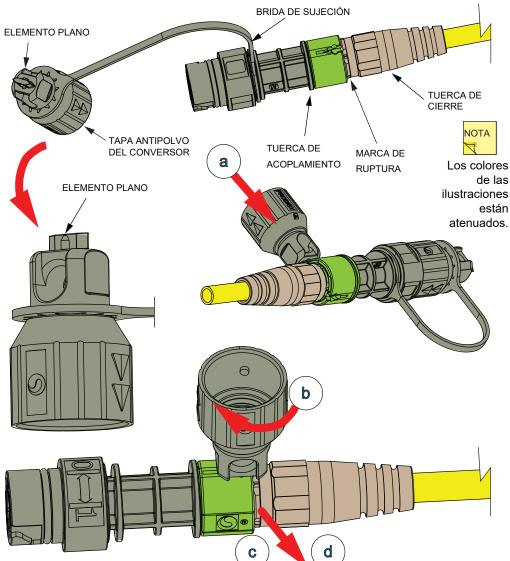
Retire el conversor hembra de la siguiente manera: (a)Gire la tuerca de cierre 45º en la dirección mostrada para desbloquear el conector Prodigy del conversor hembra, (b) extraiga el conversor del conector Prodigy.
