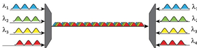
Figura 6: SWDM combinando 4 comprimentos de onda de 850 nm a 940 nm
