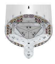
60-port sector antenna, 12x 617-960MHz, 24x 1695-2690MHz 65° HPBW and 24x 3300-3800 MHz, 90° HPBW, 15x RET
